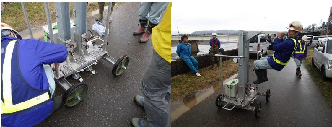
左の写真がアウトリガー出した時、右の写真が実際に人がぶら下がった時。左の写真のように実際機械を昇降させる側のアウトリガーを出してあげる事により、右の写真のように人が体重をかけても安定している事が確認出来ます。実際に動かしてみると、個々のパーツ自体重いのですが平坦な箇所では、安定してスムーズに走る事が確認出来ました。
