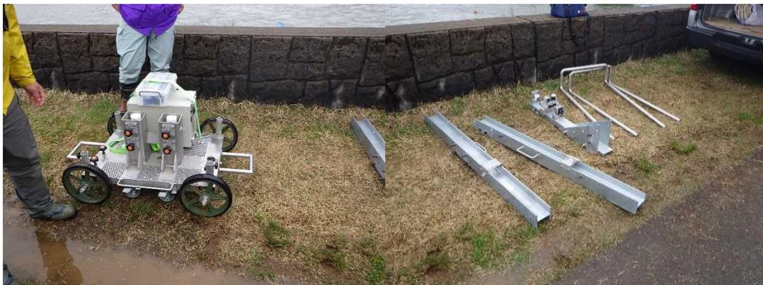
左の写真が移動式台車の基礎になる台座部分、右の写真が支柱等になります。個々のパーツが非常に重い為、高水時に一人での組み立てが困難ではありますが、組み立て自体に複雑な構造がないので2名～3名で行えば15分ほどで組み立てが行えると思います。
